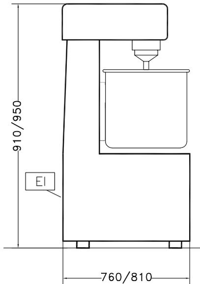
EI = Conexión eléctrica (energía)
